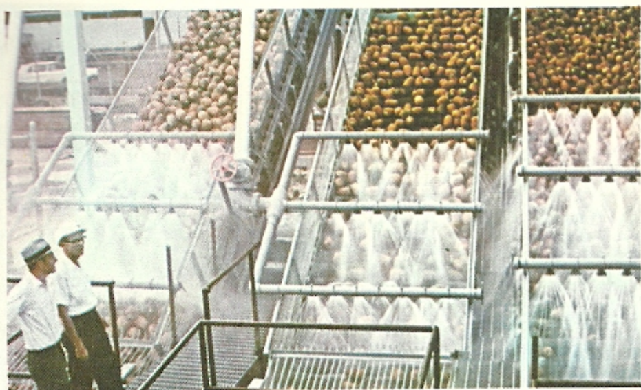
ドール社の新しい果実処理機で水洗いされながらカン詰め工場に送られるパイナップル。
